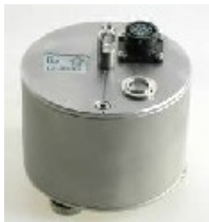
Рис. 3. Внешний вид сейсмометра «СМЕ-4111-ЛТ» (а), LE-3Dlite (б) и регистратора «Байкал-АСН88» (в)
