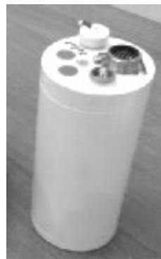
Рис. 3. Внешний вид сейсмометра «СМЕ-4111-ЛТ» (а), LE-3Dlite (б) и регистратора «Байкал-АСН88» (в)
